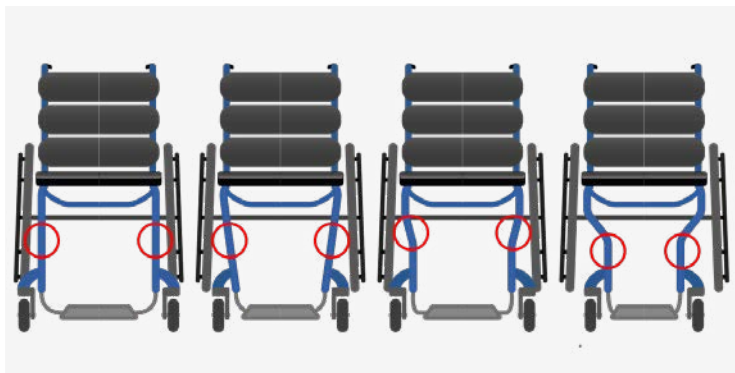
Abb. 13: Exempel: Möjliga monteringslägen
