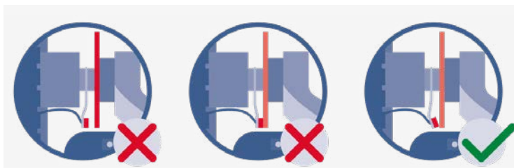
Abb. 118: Exempel på sensorposition
